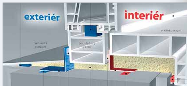
Osazení těsnicí pásky v připojovací spáře okna. Zdroj: Soudal
