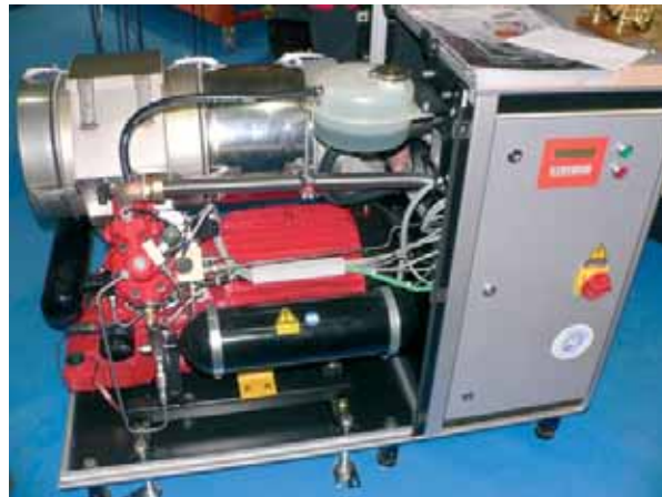
Prototyp malé plynové kogenerační jednotky se Stirlingovým motorem. Foto: EkoWATT
